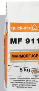
Flexibler, schnellerhärtender trasshaltiger Fugenmörtel für verfärbungsempfindliche Marmor- und Natursteinbeläge an Wand und Boden. Wasser- und schmutzabweisend. Für Fugenbreiten von 2 bis 8 mm. Für innen und außen. CG 2 WA gem. DIN EN 13888.
