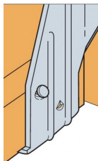
Sterkte tegen opwaartse drukkracht kan verhoogd worden door 2 nagels onder hoek van 45° te plaatsen in ondergording
