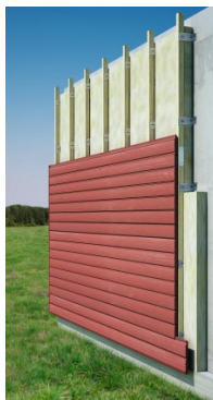
Plaatsing van een regenkap
