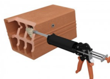
Vullen vanaf bodemgat naar buiten door bij het pompen telkens één maatstreep op de spuitmond achteruit te gaan
