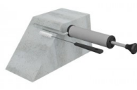
Boorgat reinigen door uitborstelen en uitblazen zoals aangegeven op de patroon
