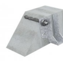
Ankerstang licht draaiend insteken. Ankerstang verstellen of hars toevoegen zolang de verwerkingstijd niet bereikt is
