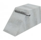
Vullen vanaf bodemgat naar buiten door bij het pompen telkens één maatstreep op de spuitmond achteruit te gaan
